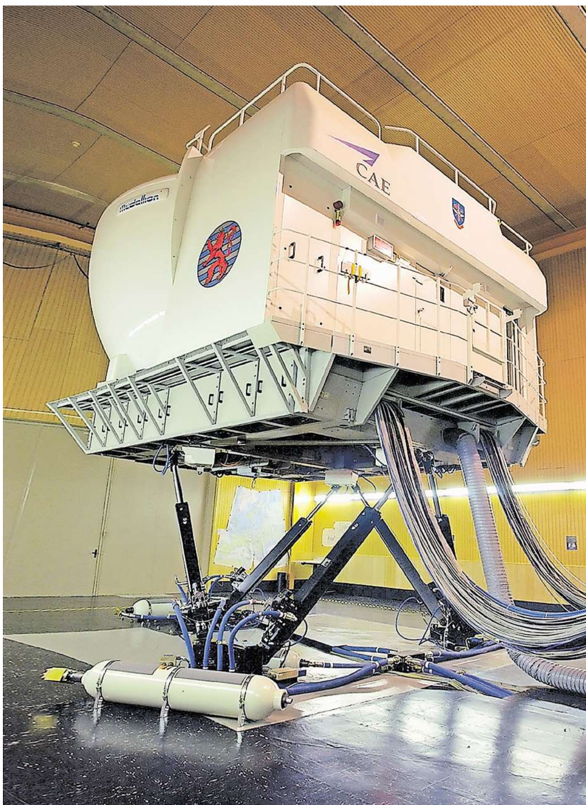
So sieht der Flugdecksimulator der CAE für das Training der Awacs-Besatzungen von außen aus. FOTO: CAE ELEKTRONIK GMBH
