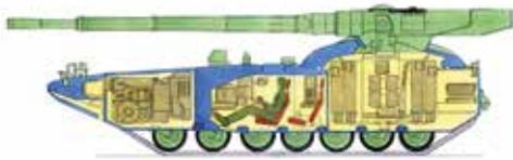
**Schnittdarstellung des Obj. 299 mit PzK 152 mm in Scheitellafettierung und Fronttriebwerk (Gasturbine)**
