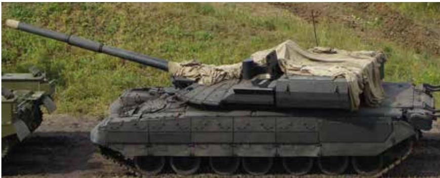
**Obj. 640 Modell 1999 auf einem modifizierten Fahrgestell des KPz T-80 U. Auffällig ist das große Gehäuse für den Ladeautomaten im Turmheck**
