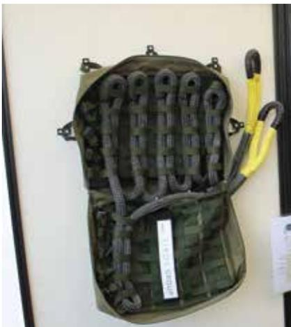
**Die kinetischen Bergeseile der Tiros Group fallen deutlich leichter als Stahlseile aus**
