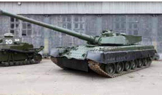
**Prototyp des Obj. 292; hier wurde eine PzK 152 mm behelfsmäßig in einen modifizierten Turm des KPz T-80 U eingebaut**
