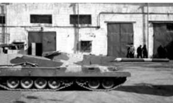
**Obj. 490 B Belka mit PzK 152 mm und zwei Fahrgestellen sowie vier Fahrwerkselementen**
