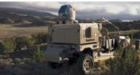
reife zur Bekämpfung von unbemannten Flugzeugen zu prüfen. Erprobt werden drei verschiedene Waffentypen: eine Hochenergielaserwaffe (High Energy Laser Weapon System, HELWS) und eine Mikrowellenwaffe (Phaser High-Power Microwave System) der Firma Raytheon sowie die direkt durch das Forschungsamt entwickelte Mikrowellenwaffe THOR (Tactical High-power Operational Responder).
